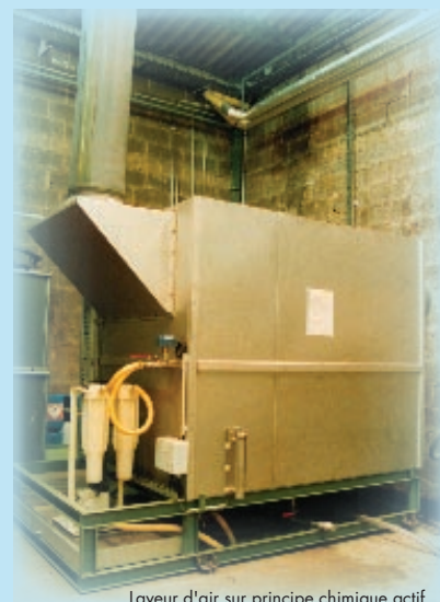
Laveur d'air sur principe chimique actif
